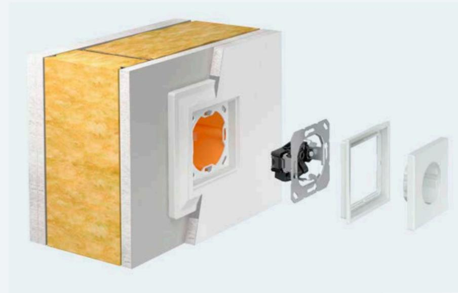
Voraussetzung bei der Montage im Trockenbau ist die doppelte Beplankung der Trockenbauwand. Der Einputzadapter hat dieselbe Aufbauhöhe wie eine Gipsplatte (12,5 mm) und ermöglicht so die form- und stoffschlüssige Verbindung mit der Oberfläche.
