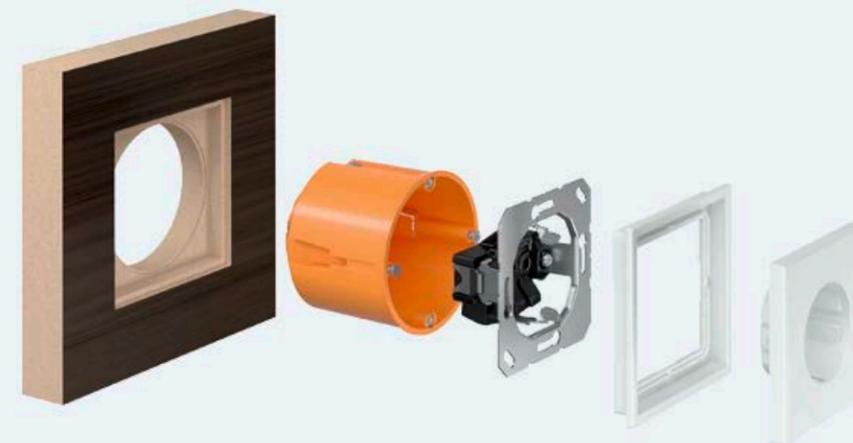
Mit Hilfe vorgegebener Zeichnungsdaten kann der Möbelbauer millimetergenau arbeiten. Um den gewünschten Einsatz, den LS ZERO Rahmen und die Abdeckung flächenbündig einzubauen, werden nach dem Fräsen des Ausschnitts handelsübliche Hohlwanddosen gesetzt.
