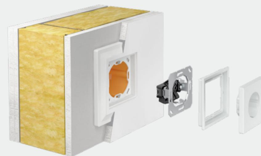
Le montage dans les cloisons creuses est possible uniquement si elles présentent un parement double. L'adaptateur de montage offre la même hauteur de montage (12,5 mm) qu'une plaque de plâtre et garantit ainsi un raccord homogène avec la surface.
