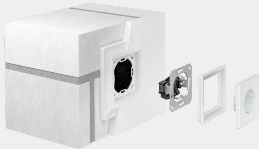
Le montage du LS ZERO s'effectue à l'aide de boîtes d'appareillage usuelles et d'un cadre fin uniformisé. Un adaptateur de montage permet l'installation affleurante. Il se confond de manière homogène avec l'enduit et empêche ainsi la fissuration. L'aide au montage fournie permet de réaliser proprement les raccords d'enduit.
